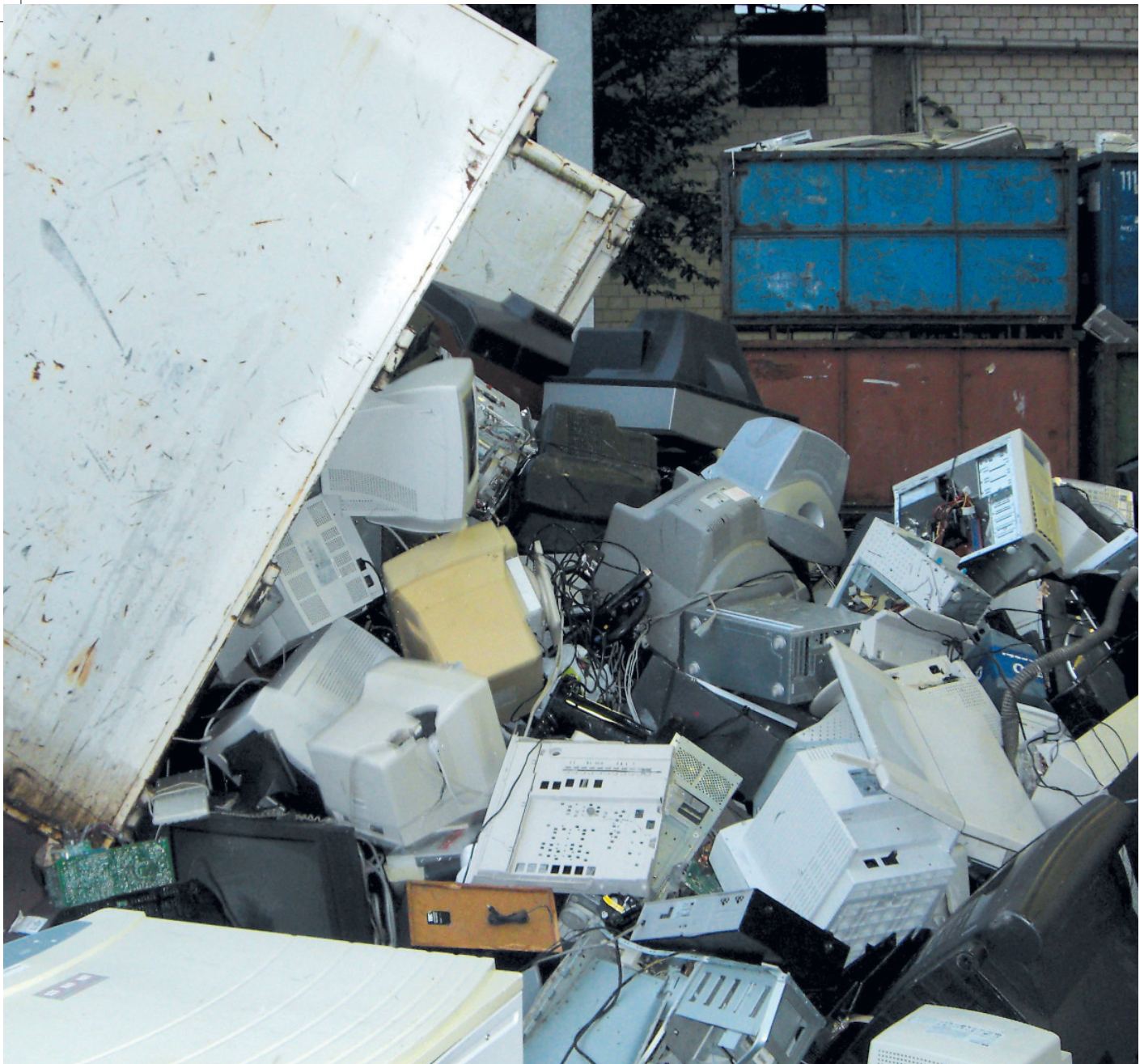
▲ 1 Incorrect collection and unloading of waste monitors and televisions Unsachgemäße Erfassung und Entladung von Bildschirmgeräten
